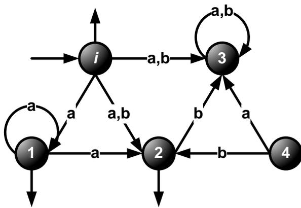
(En réalité, cet automate – appelons-le  $C'$  – est assez bizarre. Il contient un état **non accessible** 4 (où on ne peut pas arriver à partir de l'état initial) et un état **non coaccessible** 3 (à partir duquel on ne peut pas arriver à une sortie). Il pourrait donc être simplifié en enlevant ces deux états avec ses transitions ; en le faisant on obtient l'**émondé** du  $C'$  :
