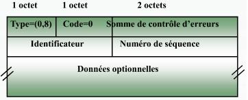
Identificateur, Numéro de séquence permettent à l'expéditeur d'associer les réponses reçues avec ses propres demandes
