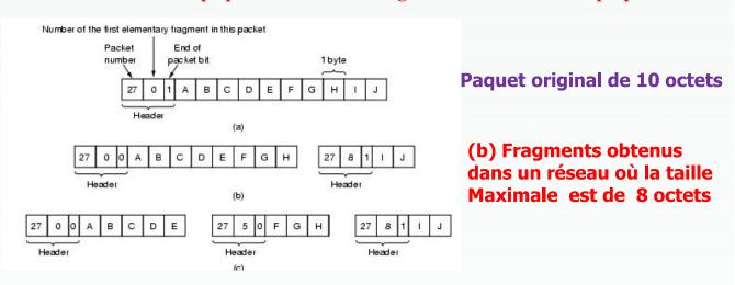
(c) Fragments obtenus après passage des paquets de (b) par un réseau où la taille maximale est de 5 octets
